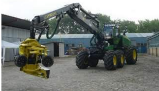
ХАРВЕСТЕР – СПЕЦИЈАЛИЗОВАНА МАШИНА ЗА СЕЧУ И ИЗРАДУ ДРВНИХ СОРТИМЕНАТА
